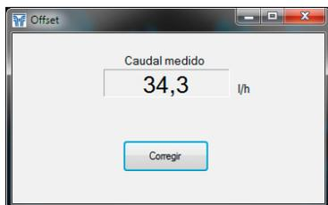
Para corregir el offset, el caudal en la instalación debe ser cero, es decir, el líquido que hay en el interior de la tubería donde está instalado el caudalímetro debe estar totalmente parado. Además, debe garantizarse que la tubería está completamente llena de líquido para que este ajuste sea efectivo.
